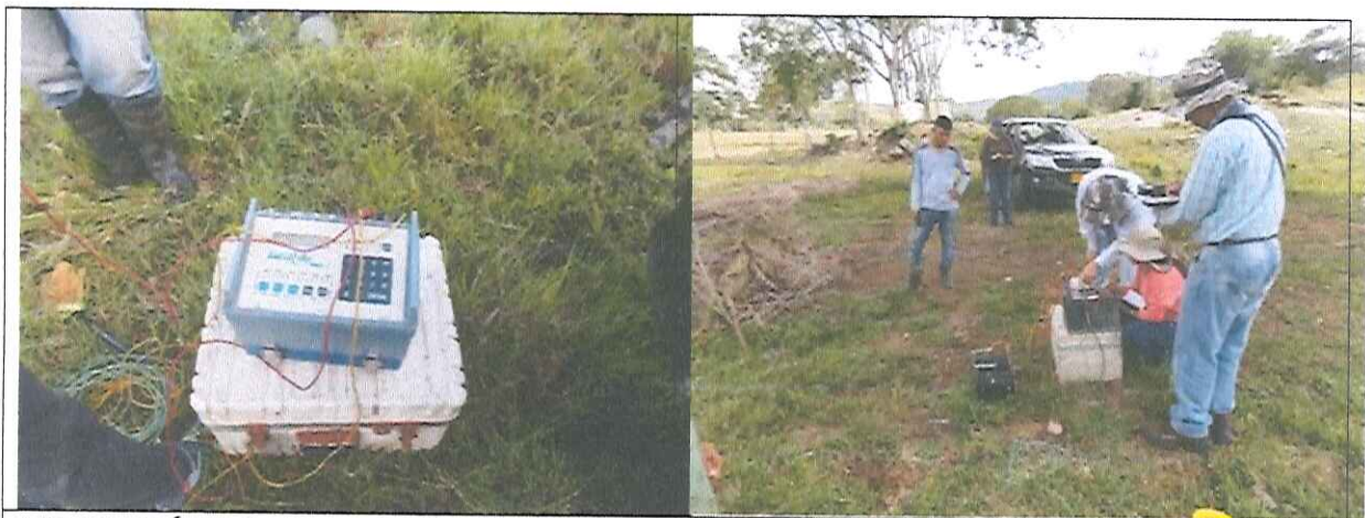
FOTOGRAFÍA 3. Equipos y Realización de SEV en el área del Sector La Mina, municipio de Armero Guayabal -Tolima.
