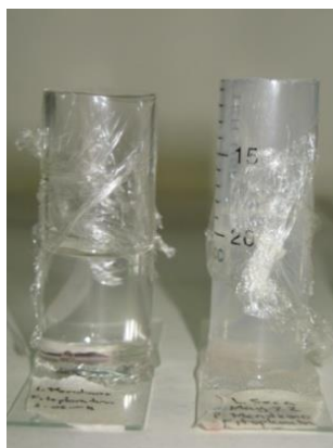
Figura 3.10. Cámaras de sedimentación de Ultermohl para la observación y conteo de las muestras de plancton.
