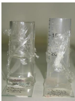
Figura 3.3. Cámaras de sedimentación de Ultermohl para la observación y conteo de las muestras de plancton.
