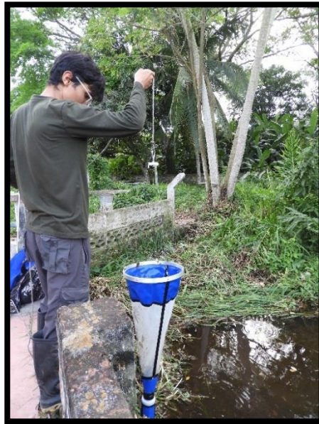
Foto 6. Método de muestreo colecta de fitoplancton Fuente: El autor (2022)
