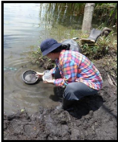
Foto 10 y Foto 11. Lavado de sedimentos en tamiz para la recolección de macroinvertebrados acuáticos
