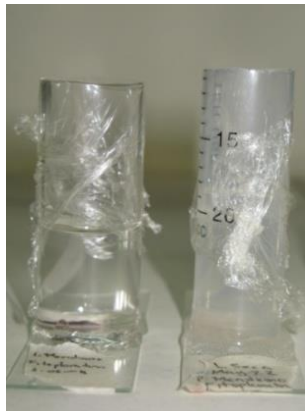
Figura 3.9. Cámaras de sedimentación de Ultermohl para la observación y conteo de las muestras de plancton.
