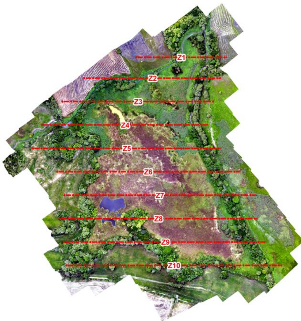
Figura 2-13. Modelo Topobatimétrico y distribución de perfiles (transectos) definidos para el humedal El Zancudal, Ambalema-Tolima.
