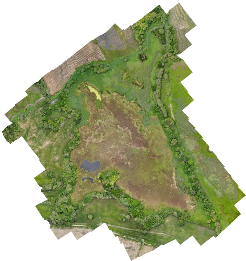
Figura 2-13. Levantamiento topográfico del terreno para el humedal El Zancudal, Ambalema-Tolima.
