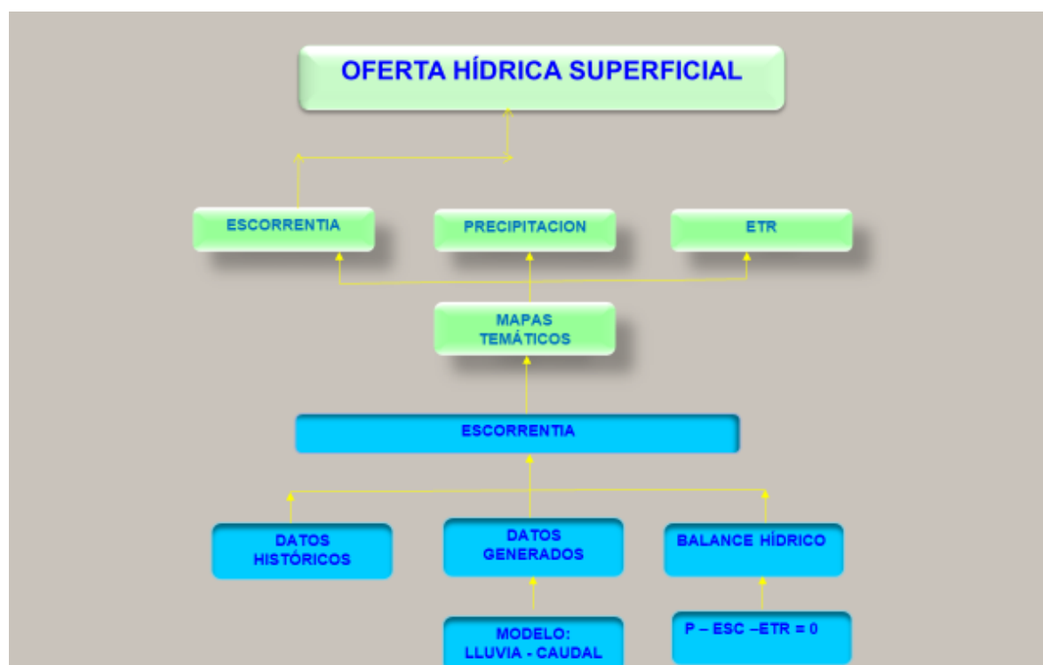
Figura 5. Flujograma para determinar la oferta hídrica superficial.
